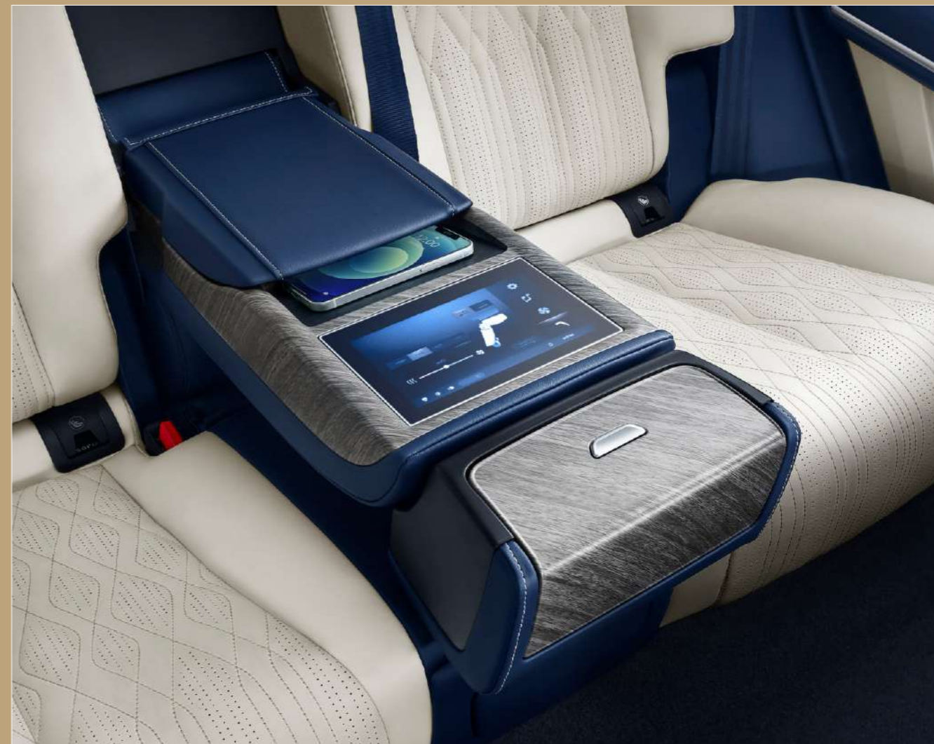
Басқару экраны (алдыңғы жолаушының отырғышын, люк пердесін реттеу, массаж функцияларын іске қосу) Артқы қатардағы жолаушыларға арналған сымсыз зарядтау құрылғысы
