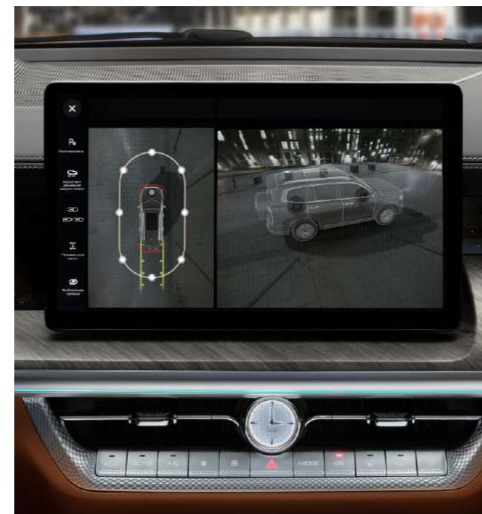
«Мөлдір капот» функциясы бар айнала шолу камерасы
